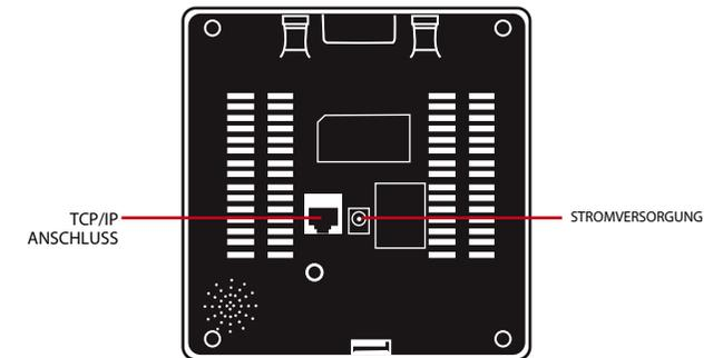
Verbindungsunkte für Strom und Datenübertragung befinden sich auf der Hinterseite des Terminals. Für eine korrekte Installation, sehen Sie sich die folgenden Diagramme an.
