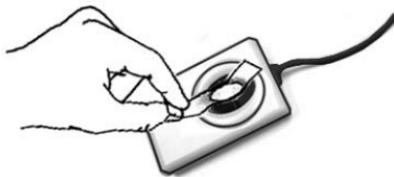
在频密的使用情况下，感应器的表层会暗淡且无光泽。倘若出现这样的情况，可以使用带有少量的氨基玻璃清洁液的纤维布（不可使用纸张）抹拭表层。
