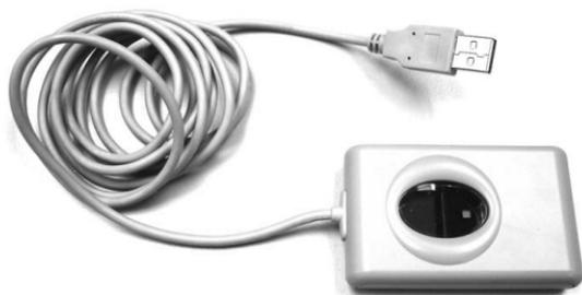
图 1: 拥有 USB 介面的 FingerTec® OFIS 扫描器。
