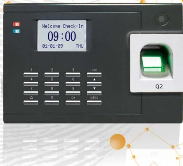
Q2 考勤和门禁系统可以存储标准的1千500 枚指纹模板和5万条记录。它非常适合中小型企业的办公室使用。Q2 的指纹感应器特别的准确和高效。每次它可以在少过2秒内提供准确的核对结果。
