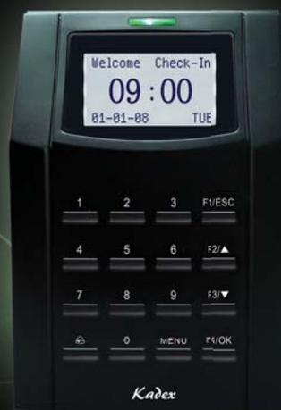
*Kadex* 是考勤與門禁管理系統的 RFID 感應卡閱讀器，它支援 RFID 的感應卡，5位數的密碼或兩者并用。*Kadex* 與安全警報系統聯系，以便在盜竊事件發生時或在威迫下使用 RFID 感應卡的時候即刻通報安全警報系統。*Kadex* 也可以結合火警系統，以便火災發生的時候第一時間開啓所有的門口。
