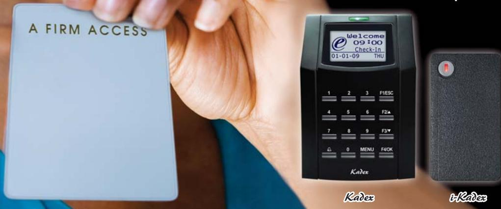
Считыватель Kadex предназначен для контроля доступа и учета времени присутствия и поддерживает карту стандарта RFID, 5-значный пароль или комбинацию RFID карты и пароля. Считыватель Kadex может быть подключен к системе охранной сигнализации для предупреждения в случае взлома или использовании функции тревоги. Также, Kadex может быть подключен к системе пожарной сигнализации для разблокирования всех дверей в случае пожара.
