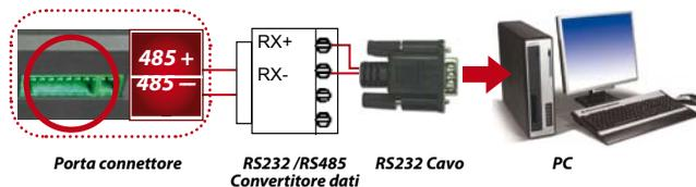
**Connessione rete RS485** - Collegamento a più computer con connessione a margherita.
