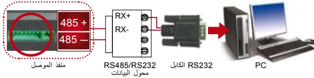
توصيل شبكة من النوع RS485 - التوصيل بأكثر من جهاز كمبيوتر باستخدام توصيل من النوع Chain Daisy.
