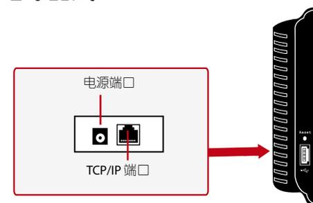
请使用包装中提供的电源适配器，或者你可选择 5VDC 2A 规格的线性电源。将电源适配器的一端连接到终端机，另一端则连接到电源插座。切勿超过所建议的电压或电流，以免损坏终端机。
