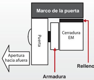
Con una placa de relleno conectada encima de la cerradura EM.
