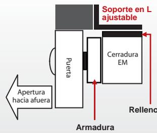
Instalación con el soporte en L ajustable cuando el marco de la puerta es estrecho.
