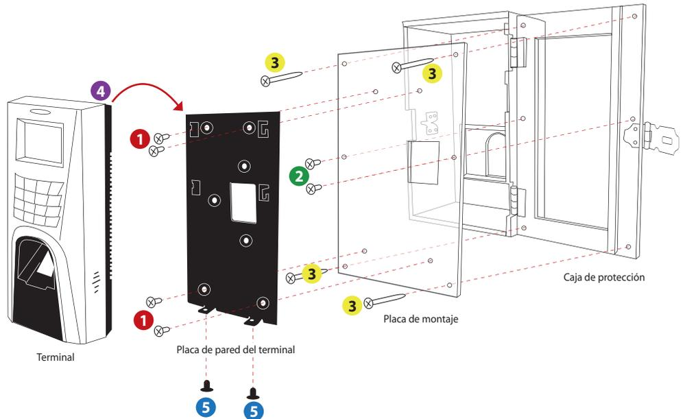
1. Coloque correctamente la placa de pared en la superficie superior en la placa trasera; apriete los pernos y las tuercas para unir estas dos placas juntas de forma segura.
