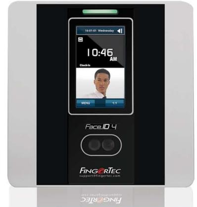
FingerTec Face ID 4 是 FingerTec 的全新功能强大的脸部识别主机，凭着它的非接触式生物识别技术提供坚实的身份验证，在区区几秒钟内识别脸部，以处理准确的考勤报告。此主机已安装最新的脸部识别算法 Biobridge VX 7.0，在登记过程中检测脸部特征，而且更快和更准确地验证；同时，由于备有高解析度摄影机和红外线功能，即使在最微弱的灯光下，也能检测脸部。功能乃专门定制，本机可用作时间考勤。对于中小型企业，以及正在物色可靠，非接触式解决方案的客户而言，Face ID 4 是最理想的解决方案了。
