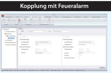
Erlaubt das automatische Öffnen von Notausgängen im Falle eines Feueralarms.
