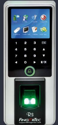
R3是FingerTec的最新生物识别门禁与考勤产品，它结合了现代技术、出色的设计和惊人的功能于一身。本机设有醒目的2.4吋彩色LCD显示器和直观触摸面板，品质优良，可防日常使用的磨损。R3备有多种验证方法，包括指纹、刷卡和密码，对忙碌的用户最为方便。本产品附有完美的门禁软件Ingress，它具备强大的门禁功能和完善的考勤功能，完全不需要额外费用。有了R3，生活更加精彩和安全，无需带着大串钥匙，出入便利无忧。
