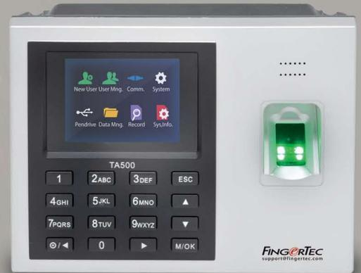
如果您正在物色一个负担得起、可靠和简约的生物识别考勤系统，TA500是您最终的选择。它的闪存记忆体在任何时候均可容纳两千个指纹模板和八万笔交易记录。TA500验证指纹、密码，经要求可嵌入刷卡技术。TA500配备了最常用的IP通信方法和USB闪存盘，是功效最强大的简约型考勤系统，适合您的中小型办公室使用。
